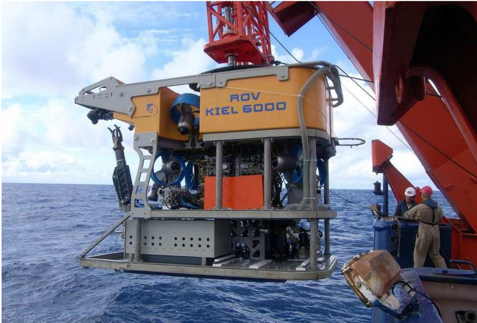
Tauchroboter ROV Kiel 6000, mit dem deutsche Forscher die Tiefsee nach Bodenschätzen absuchen (Foto: AUV-Team, GEOMAR Helmholtz-Zentrum für Ozeanforschung Kiel)
